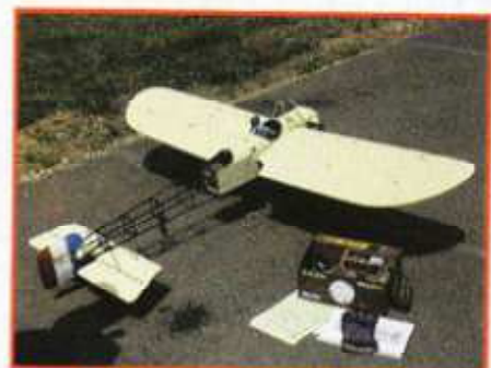
Le Blériot possède une aile à faible allongement.
